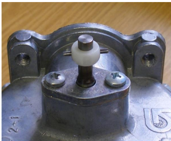
Рис. 5. SIP, закрепленный на объемном измерителе
