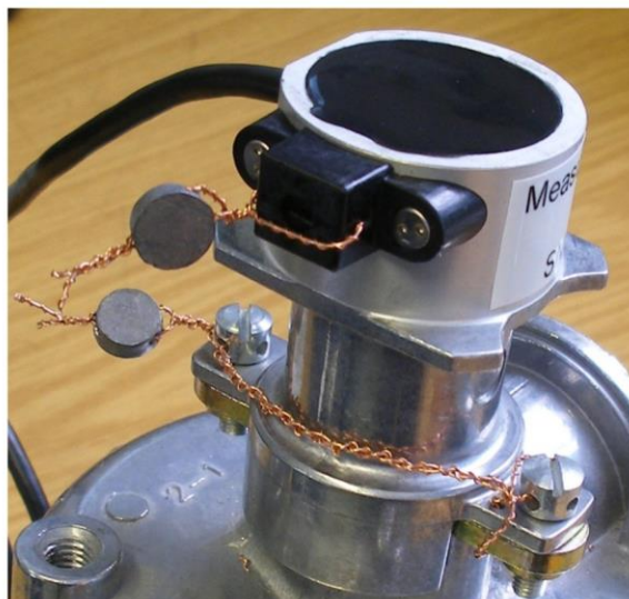
Рис. 6. SIP, закрепленный и опломбированный
