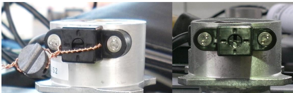
Рис. 2. Калибровочное реле на корпусе SIP в закрытом (слева) и открытом (справа) положениях
